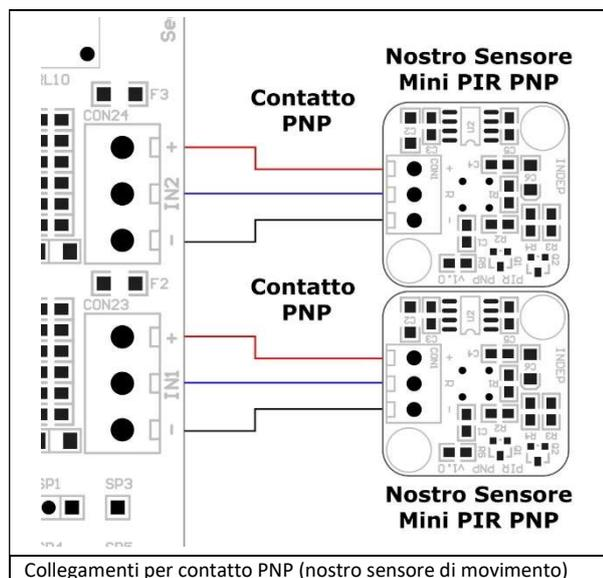
In cui la linea “+”, la linea “R” e la linea “-” del morsetto sulla scheda Sequencer (CON23 o CON 24) sono connessi con le rispettive linee “+”, “R” e “-” del nostro sensore. Si noti che il sensore non necessita di alimentazione esterna ma viene alimentato direttamente dalla scheda Sequencer.
